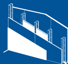
TABIQUERÍA EN SECO
